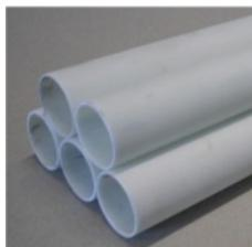
**Silglass** - имеет более высокую температурную и механическую прочность по сравнению с обычным Ероху glass, идеален для импидоров возвратного потока. Экономически не целесообразно использовать для прямоточных импидоров.
